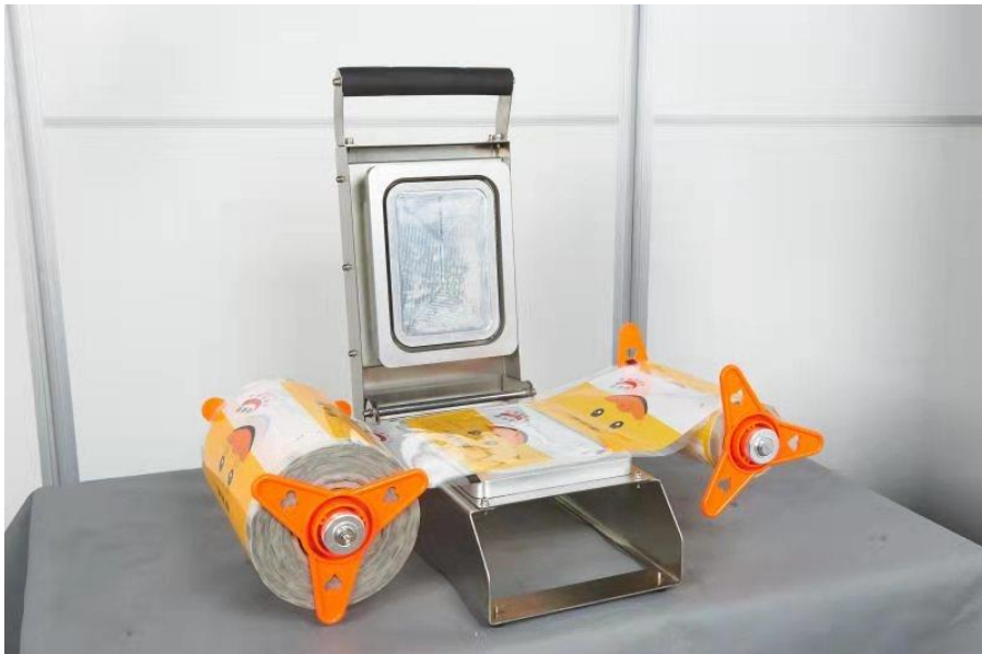
Рис1 Фотооборудования. С продольными протяжкой пленки. Представлена модель TP-100S
